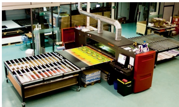
Vutek QS 2000: Mit dem Großformatsystem werden Deckenhänger auf 3 mm starkes Forex-Material gedruckt.
